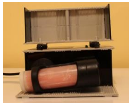
Фиг. 44. Комбинация от възвратно-постъпателни движения за разбъркване на капсулите с пластмаса
