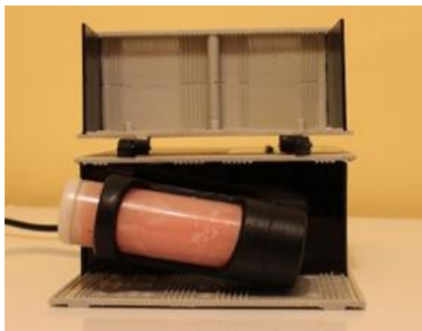
Фиг. 43. Комбинация от възвратно-постъпателни движения за разбъркване на капсулите с пластмаса
