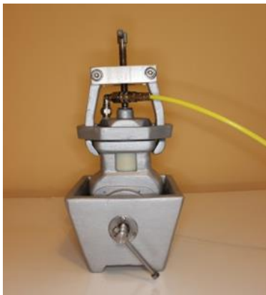
Фиг. 40. Кювета с уплътнен въздушен капак и захранващ извод за високо налягане
